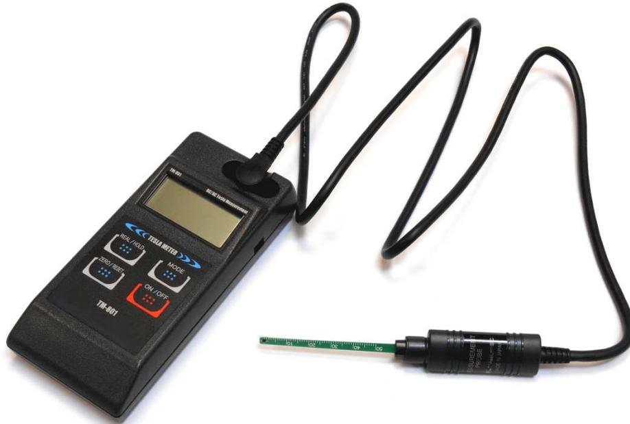
**Application :** Ce teslamètre/gaussmètre portable est utilisé pour mesurer les champs magnétiques en courant continu et alternatif.
