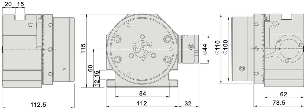
Exécution : Mandrin en acier à outils, trempé et rectifié. Montage sur appareil équipé du faux-plateau référence 6001/09 type SC40.
