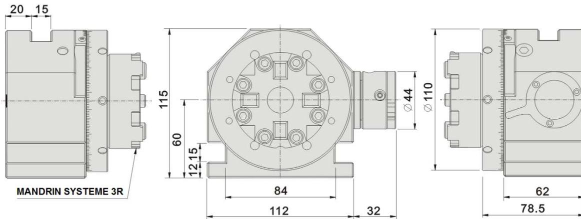
Exécution : Mandrin système 3R. Montage sur appareil équipé du faux- plateau référence 6001/09 type DFPF60
