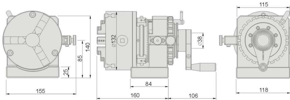
Exécution : Mandrin en acier à outils, trempé et rectifié. Montage sur appareil équipé du faux-plateau référence 6001/08 type ARFP85.
