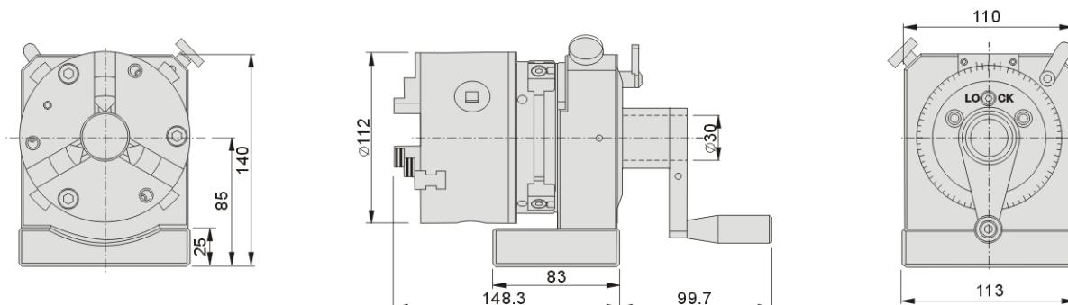
Applications : Transforme une rectifieuse plane en rectifieuse manuelle cylindrique.
