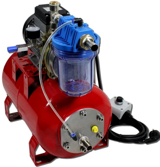
Application : Le groupe de vide assure le maintien du vide pendant l'opération d'usinage entre le plateau à dépression et la pièce à usiner. Les pompes à vide à anneau liquide utilisent le liquide de coupe du centre d'usinage qu'elles refoulent ensuite dans le circuit de la machine. Elles sont donc particulièrement recommandées pour les usinages sous fort arrosage.
