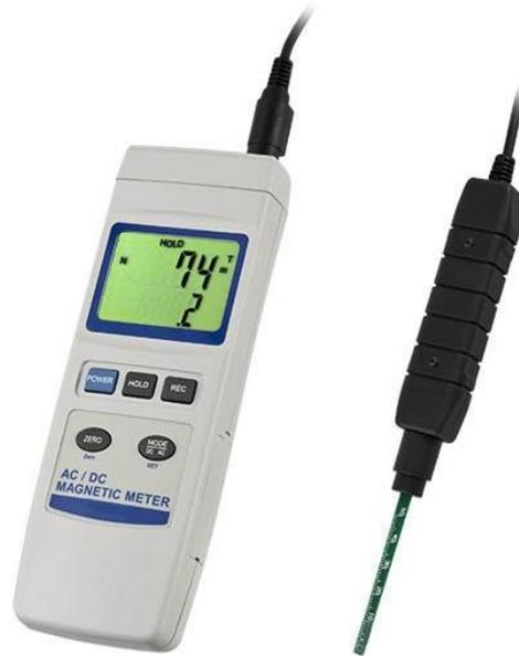
Application : Ce gaussmètre portable est utilisé pour mesurer les champs magnétiques en courant continu et alternatif.
