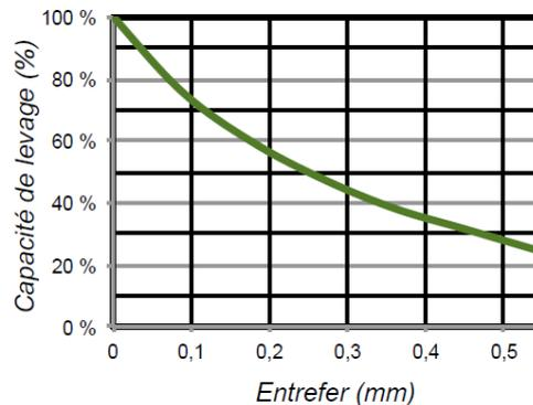
**Applications :** Levage de charges ferromagnétiques planes jusqu'à 120 Kg (coefficient de sécurité x 3) avec cycle automatique de magnétisation et démagnétisation.
