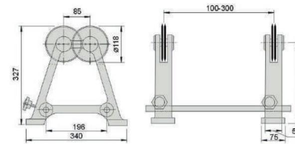
**Application :** Equilibrage statique de meules jusqu'au diamètre 508 mm.
