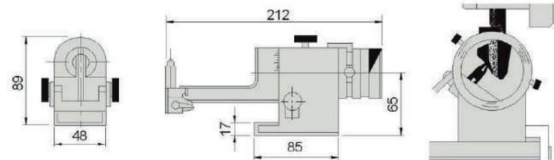
**Applications :** Réalisation rapide et précise d'angles et rayons concaves et convexes sur meules.
