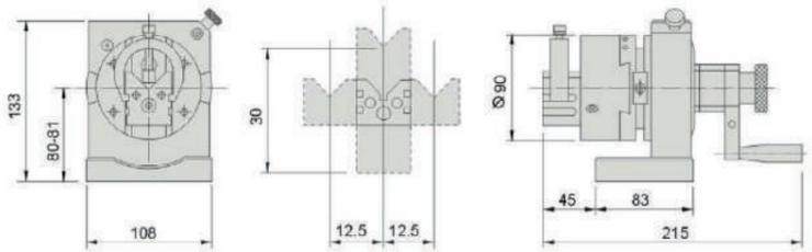
**Applications :** Sur rectifieuse plane, rectification de poinçons et profilage de meules.
