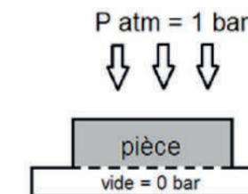
Il convient en réalité de tenir compte de la performance du système de dépression et des pertes de charge dans le circuit et d'appliquer la correction correspondante soit environ :
