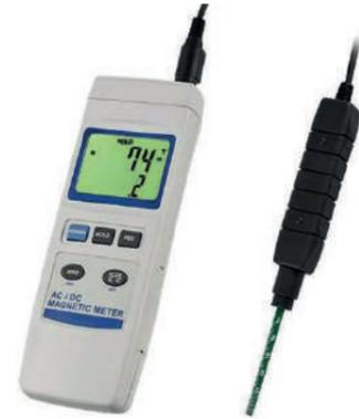
**Application :** Ce gaussmètre portable est utilisé pour mesurer les champs magnétiques en courant continu et alternatif.
