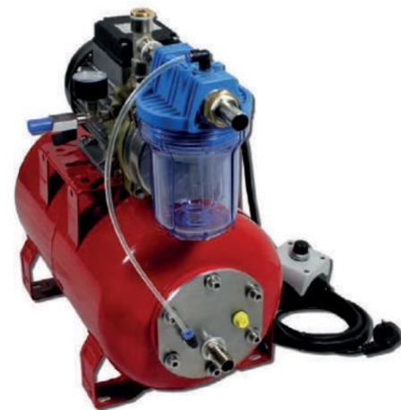
**Application :** Le groupe de vide assure le maintien du vide pendant l'opération d'usinage entre le plateau à dépression et la pièce à usiner. Les pompes à vide à anneau liquide utilisent le liquide de coupe du centre d'usinage qu'elles refoulent ensuite dans le circuit de la machine. Elles sont donc particulièrement recommandées pour les usinages sous fort arrosage.
