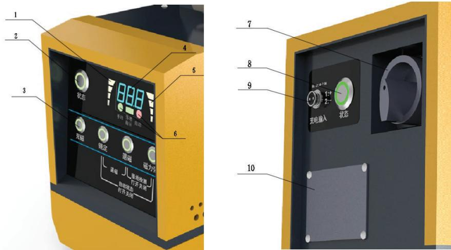
1 : Indicateur d'alimentation : Indique la puissance de la batterie. Lorsque tous les cubes s'allument, cela signifie que la batterie est pleine à 100%. Chaque bloc représente 25% de charge. Lorsque la puissance est trop faible, le contrôleur indique un code d'alarme E80. À ce moment-là, la batterie doit être rechargée. En état d'alarme, l'aimant ne peut être que démagnétisé et non magnétisé.
