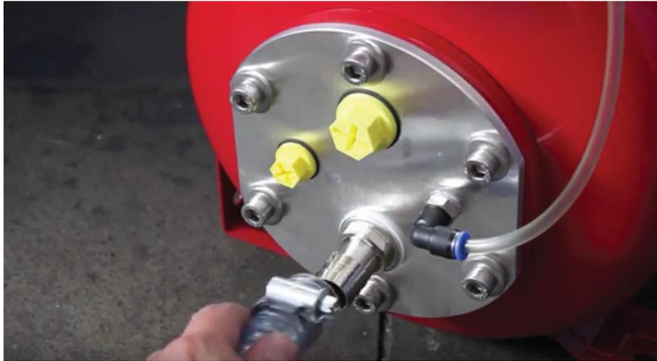
Installer le clapet anti-retour en bout du tuyau, serrer le collier et immerger le clapet dans le liquide de coupe du bac de la machine, vérifier qu'il reste bien en place sous le niveau du liquide.
