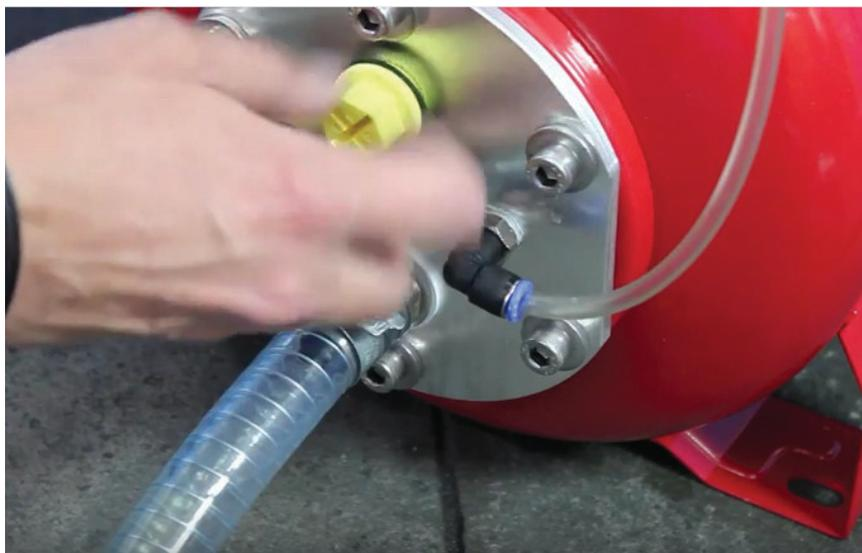
Faire le plein avec de l'eau propre jusqu'à apparition du liquide dans le petit tuyau d'équilibrage. Revissez le bouchon d'obturation.
