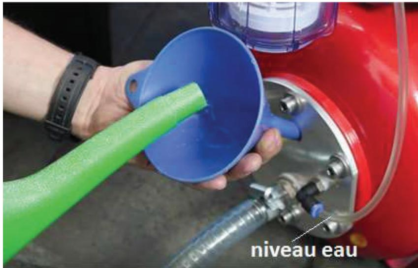
IV. Dévisser le bocal du filtre et le remplir d'eau, remonter le bocal.
