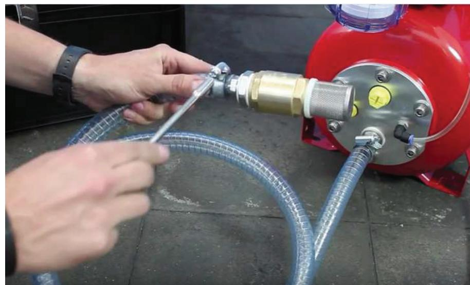
III. Oter le bouchon de remplissage du réservoir de la pompe
