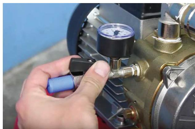
Ôter le bouchon de remplissage de la pompe et faire le plein jusqu'à écoulement par le robinet  $\frac{1}{4}$  tour. Refermer au 3/4 le robinet  $\frac{1}{4}$  tour et revisser le bouchon de remplissage de la pompe (ce robinet anti-cavitation permet de régler le niveau de vide et ne doit jamais être fermé complètement)
