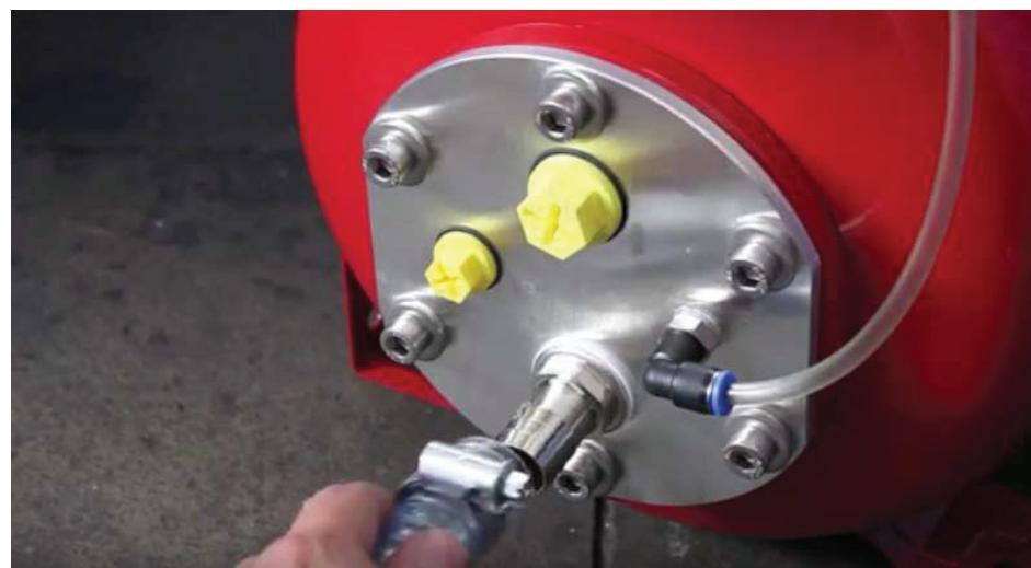
Installer le clapet anti-retour en bout du tuyau, serrer le collier et immerger le clapet dans le liquide de coupe du bac de la machine, vérifier qu'il reste bien en place sous le niveau du liquide (100 litres de liquide de coupe minimum)
