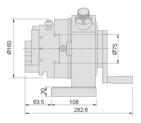
Applications: Transforme une rectifieuse plane en rectifieuse manuelle cylindrique.
