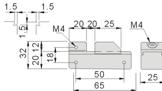
**Exécution :** En acier à outils, trempé et rectifié. Système d'approche rapide à ancre du mors mobile. Livré avec clé.
