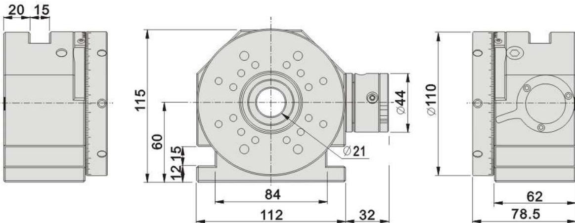
**Application :** Sur rectifieuse plane, rectification de poinçons
