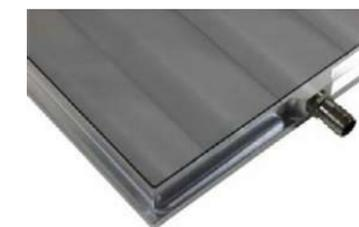
Ce type de plateau est plus particulièrement destiné à l'usinage de feuilles fines (papier, plastiques, métaux précieux). La très faible dimension des trous (voire l'absence de trous dans la cas des plateaux microporeux) évite la déformation de la feuille à usiner.
