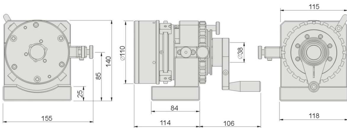
**Exécution :** Mandrin en acier à outils, trempé et rectifié. Montage sur appareil équipé du faux-plateau référence 6001/08 type ARFP85.
