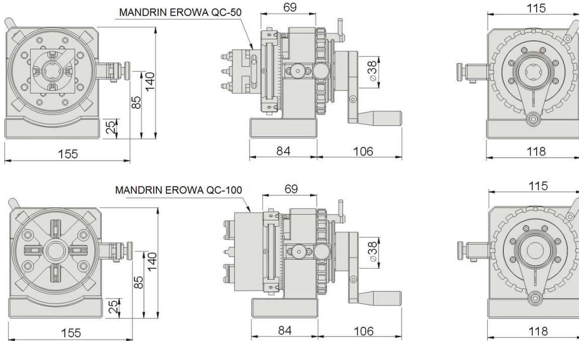
Exécution : Mandrin Quick Change EROWA . Montage sur appareil équipé du faux-plateau référence 6001/08 type ARFP85.
