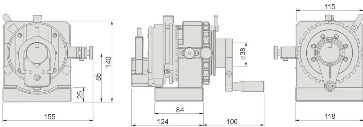
**Applications :** Transforme une rectifieuse plane en rectifieuse manuelle cylindrique.
