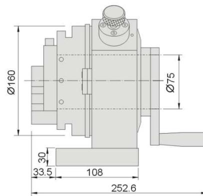
**Applications :** Transforme une rectifieuse plane en rectifieuse manuelle cylindrique.
